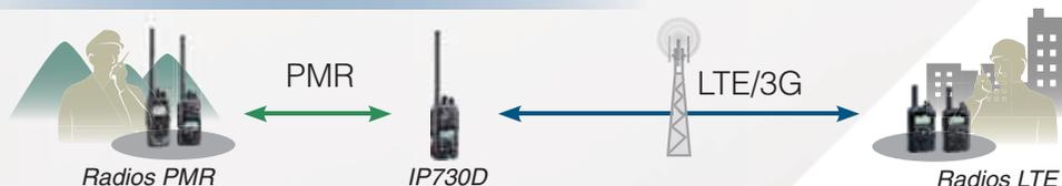
La fonction "bridge" assure également l'établissement ponctuel d'une connexion entre deux réseaux PMR distants même en cas d'utilisation de fréquences ou de canaux différents.
